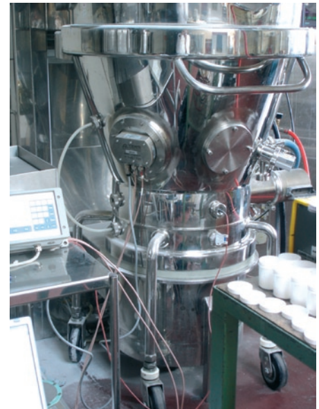
Einsatz eines Mikrowellenresonators in einem Wurtschichttrockner
