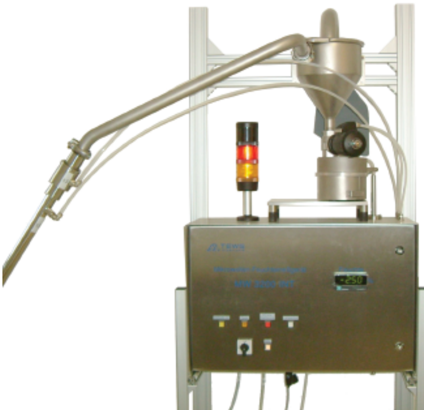
Fig. 3 Equipo MW4200, versión especial para medición individual de cápsulas de gelatina y de celulosa.
